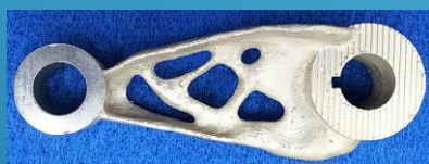
トポロジー最適化部品 (SUS316L)
