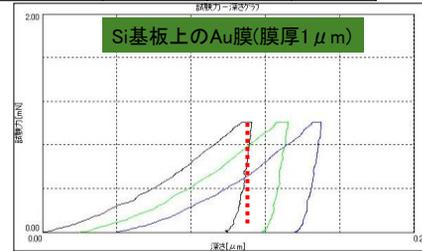
Hmax(深さ最大値)を比較すると、SiO<sub>2</sub>が小さくAuが大きい。⇒ SiO<sub>2</sub>が硬い
